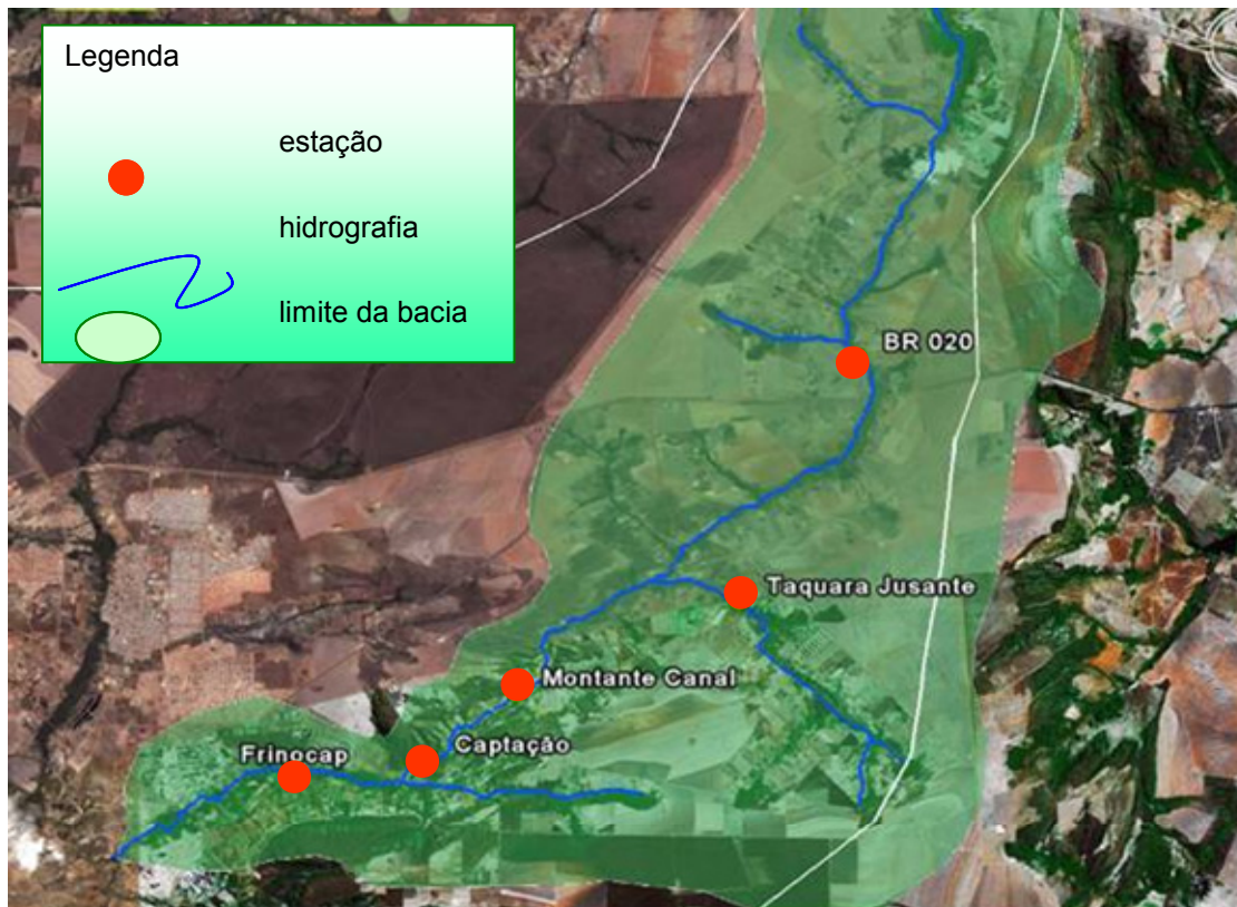
Figura 1 - A localização das estações fluviométricas utilizadas para monitorar o comportamento hidrológico dos principais rios da bacia do Ribeirão Pipiripau.
