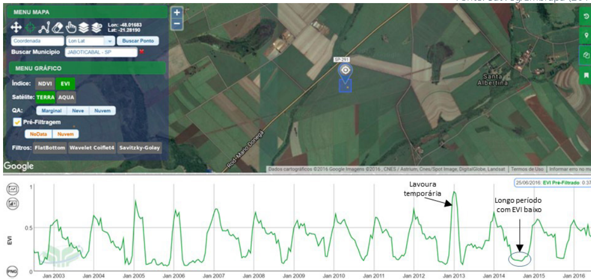
Figura 5. Trajetória do índice de vegetação (EVI/MODIS) de 2001 a 2016 de um pixel em área de cana, no município de Jaboticabal/SP.
