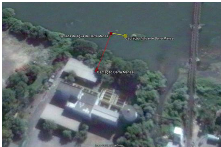
Ilustração da alternativa de instalação de conjuntos elevatórios sobre flutuante para transposição da água para a torre de tomada existente (aproveitamento das linhas de recalque existentes).
