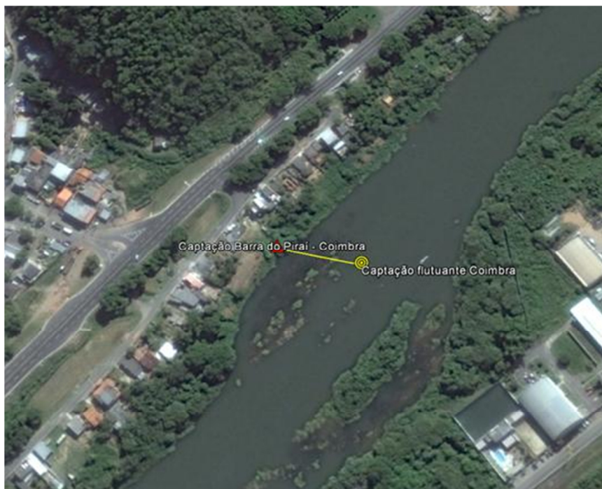
Ilustração da alternativa de relocação do ponto de captação por meio de flutuante.
