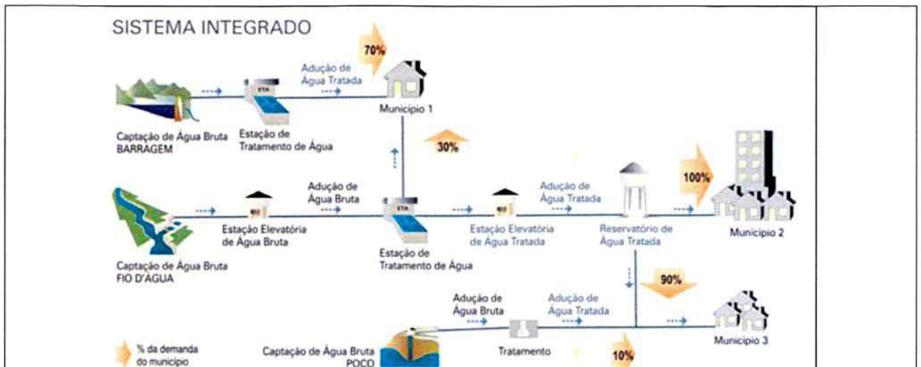
Figura 1 – Esquema de sistema integrado de produção de água Fonte: Atlas Brasil – Abastecimento Urbano de Água, ANA (2010)
