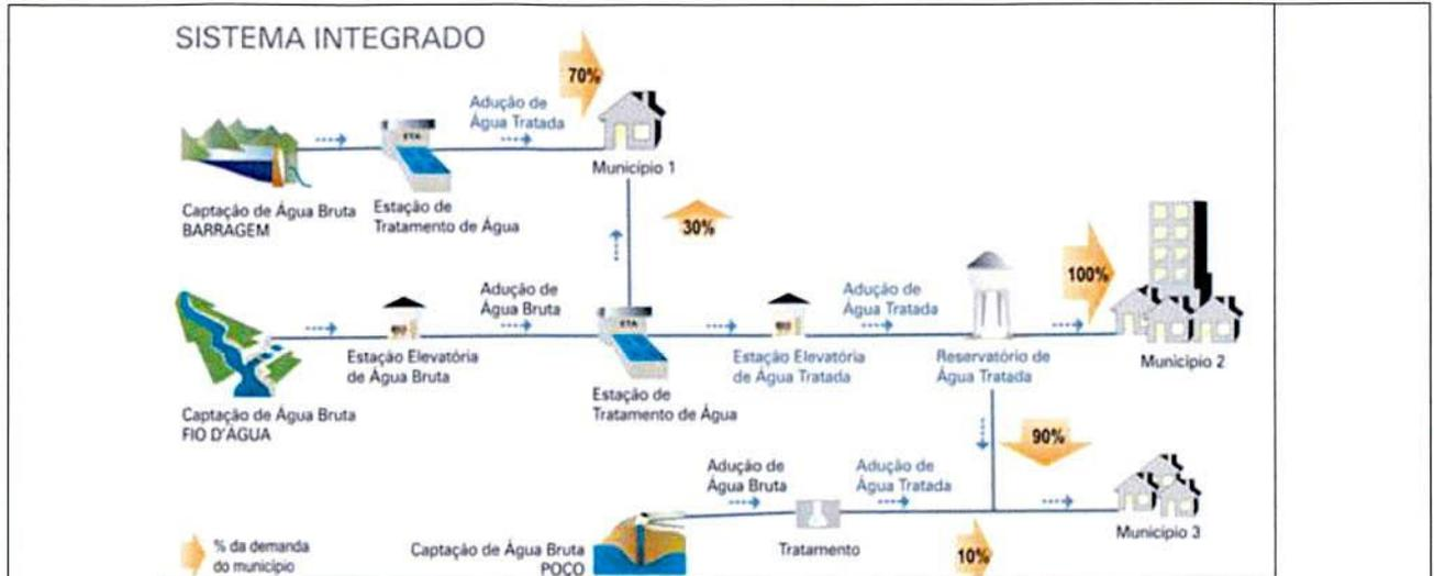
Figura 1 – Esquema de sistema integrado de produção de água
